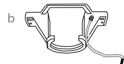
**b.** soporte de montaje (ensamblado a la cubierta decorativa). 1 unidad
